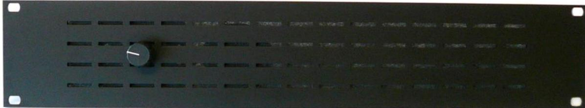
Der **proKL06-50/T-LSR-EN54** eignet sich optimal als Kontrolllautsprecher in einer 19" Rackzentrale und kann mittels Lautstärkesteller auf die gewünschte Lautstärke ein- bzw. komplett ausgestellt werden. Zudem ist der Steller mit einem 24 Volt Pflichtempfangsrelais und einer Thermosicherung ausgestattet, sodass der Lautsprecher auch als Komponente in einer SAA Sprachalarmierungsanlage eingesetzt werden kann.
